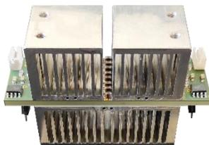
L'originalité du concept développé au sein du laboratoire G2Elab repose sur une intégration astucieuse de puces d'un semi-conducteur (transistor) dans un circuit électronique (PCB) ; le tout couplé à une optimisation du système de refroidissement, placé au plus près de la puce, afin de garantir une meilleure dissipation des pertes. **Illustration en pj.**
